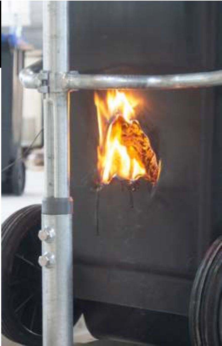
Det begynner å smelte. Det er vilkårlig hvor det til slutt smelter hull.
